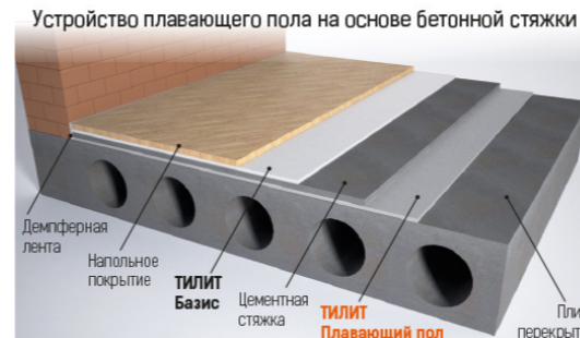
Рис. 3. Пример устройства системы плавающий пол с применением вспененного полиэтилена повышенной плотности «ТИЛИТ Плавающий пол»
